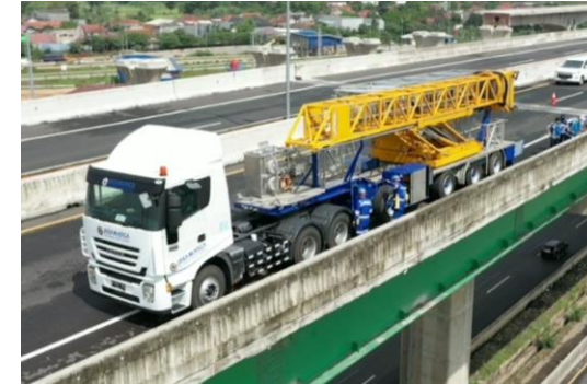
Penerapan IMS menggunakan hawk eye dan bridge inspection terintegrasi aplikasi.
